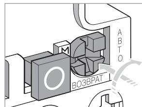
При повороте влево переключатель выводится из зацепления и переходит в режим кнопки, при нажатии на которую осуществляется ручное повторное включение. При нажатии на переключатель и повороте вправо выполняется режим автоматического повторного включения. Переключатель остается в положении автоматического повторного включения до принудительного возврата в положение ручного повторного включения.
