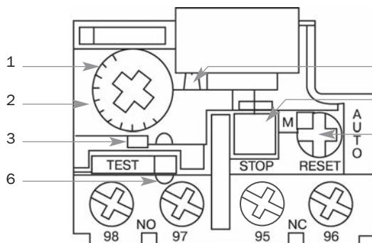
Конструкция электротепловых реле допускает возможность регулировки уставок. Для изменения уставки срабатывания электротеплового реле открыть прозрачную крышку (1) над диском регулировки уставки. Установить необходимый ток уставки срабатывания реле вращением диска (2), совмещая значение тока (в амперах) на шкале с отметкой на корпусе.
