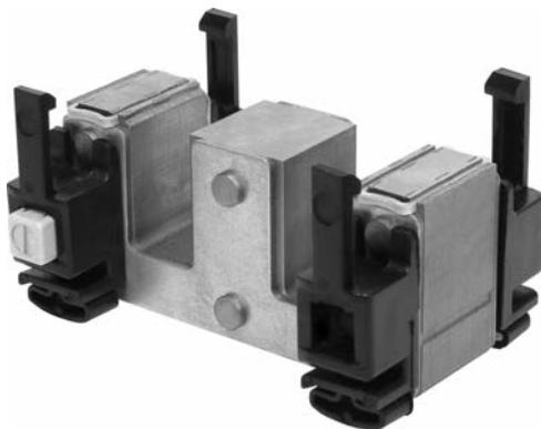
Для уменьшения динамических нагрузок на катушку при коммутациях и снижения уровня ее шума конструкция неподвижной части магнитопровода дополнена фиксаторами из эластичной пластмассы.
