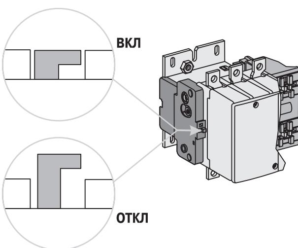
Положение контактной системы, то есть замкнуто или разомкнуто, можно определить по индикатору, расположенному в верхней части левой боковой крышки контактора. Данная конструктивная особенность значительно облегчает эксплуатацию контакторов, так как позволяет определить рабочее положение, не разбирая контактор.
