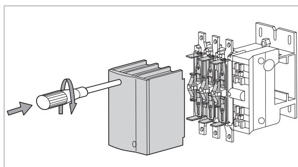
Крышка контактора, закрывающая контактную систему, легко снимается (2 подпружиненных винта поворачиваются на 90°).
