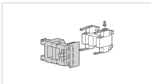
Катушка управления объединена с неподвижной частью магнитопровода. Ее демонтаж осуществляется нажатием на кнопку и выдвижением влево по специальным направляющим. Такой механизм позволяет упростить техническое обслуживание.
