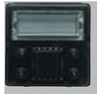
Механизм электронного терморегулятора | <b>8140.5</b><br><b>8840.5</b> | 230 В~ / 50 Гц (8140.5)<br>127 В~ / 60 Гц (8840.5)<br>Беспотенциальный выход<br>С памятью<br>Номинальная нагрузка: 3А cos φ = 0,5<br>Режимы работы<br>1) Гистерезис 0,5 °С<br>2) Понижение/повышение т-ры: ±4 °С в зависимости от заданной температуры<br>Рабочая температура от: 0 °С до 50 °С Потребление <1W<br>Накладка Арт.: N2240.5 |
