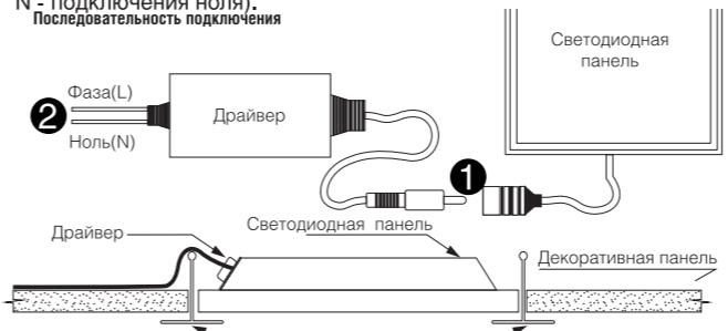
**!** Не допускается размещение светодиодного драйвера на корпусе светодиодной панели. Во избежание несчастных случаев следуйте указаниям инструкции.
