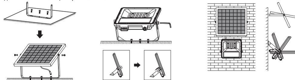
Закріпіть кронштейни на сонячній панелі та прожекторі. Для монтажу прожектора і сонячної панелі необхідно зробити отвори у поверхні, де буде встановлено прожектор, так, щоб вони співпали з отворами у кронштейні. Вмонтуйте дюбелі в отвори у поверхні. Закріпіть за допомогою гвинтів на поверхню сонячну панель та прожектор. Відрегулюйте кут нахилу прожектора. Затисніть болти кронштейна для фіксації прожектора. З'єднайте контакти прожектора та сонячної панелі.
