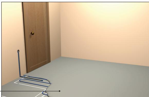
**10.** Перед укладкою фінішного покриття перевірте цілісність кабелю та ізоляції шляхом виміру опору згідно рекомендацій у першому абзаці пункту 5 на ст. 7 Інструкції.
