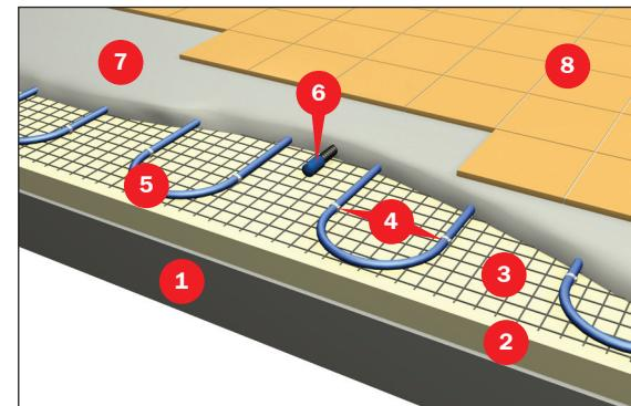
Нагрівальний кабель можна монтувати безпосередньо на тверду теплоізоляцію товщиною від 20 мм використовуючи металеву сітку діаметром дроту від 1 мм. Фіксується кабель до сітки при допомозі пластикових хомутів.
