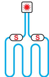
Схема укладки одножильного кабелю
