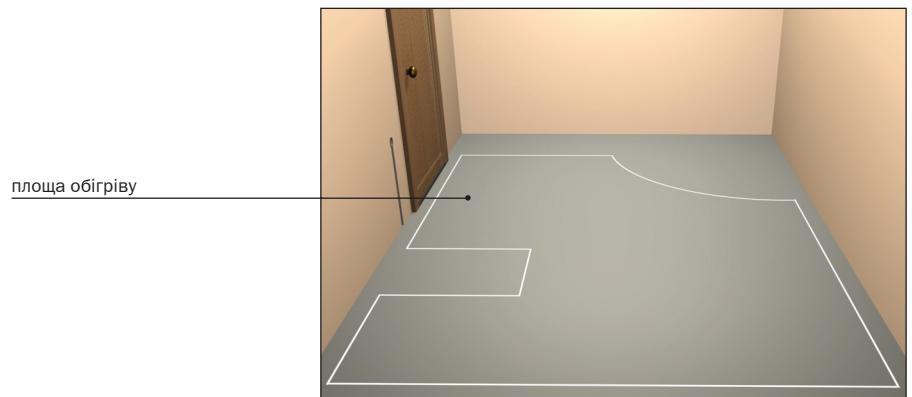
4. На виділеній площі обігріву закріпіть відрізки монтажної стрічки з кроком 0,5–0,75 м так, щоб кріпильні скоби були в одному напрямку.
