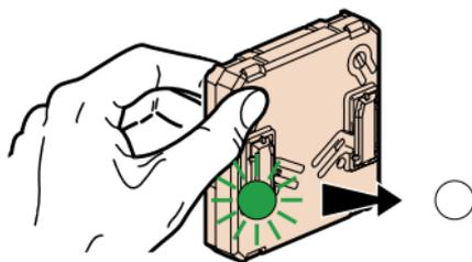
Нажмите на кнопку на корпусе модуля, чтобы его активировать: светодиод начинает мигать зеленым светом и затем гаснет.
