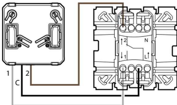
Режим кнопочного устройства
