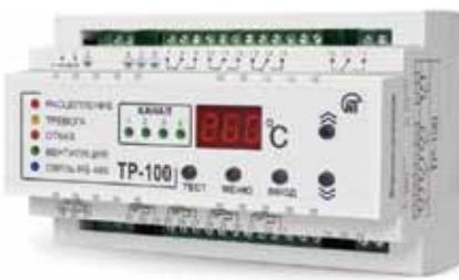
Реле предназначено для измерения и контроля температуры по четырём датчикам с последующим отображением температуры на дисплее и выдаче сигналов аварии при выходе каких-либо параметров за установленные пределы.
