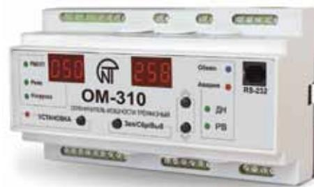
ОМ-310 обеспечивает работу с нагрузкой мощностью от 2,5 кВт до 30 кВт при использовании встроенных токовых трансформаторов и до 350 кВт при использовании внешних токовых трансформаторов, в том числе и в сетях с изолированной нейтралью.
