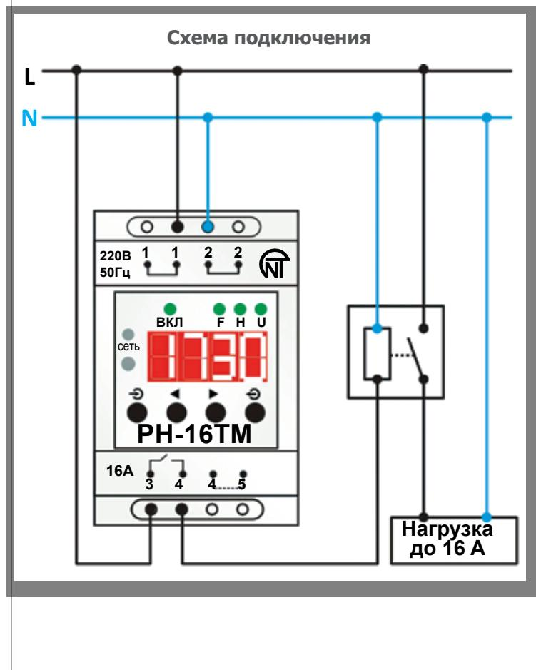
Максимальное количество программируемых событий в режиме таймер до 420. Коммутирует нагрузку до 16 А непосредственно, свыше 16 А - контактами магнитного пускателя.
