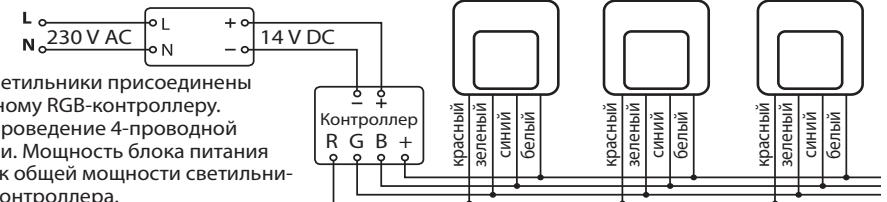
Схема 4. Светильники присоединены к центральному RGB-контроллеру. Требуется проведение 4-проводной инсталляции. Мощность блока питания подбрана к общей мощности светильников и RGB-контроллера.
