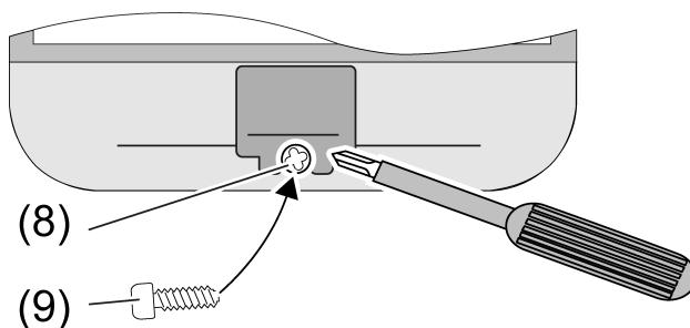
рисунок 15: Фиксация выключателя
