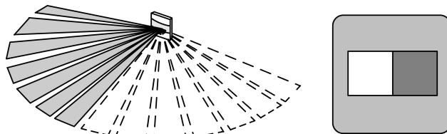
рисунок 11: Ограничение поля обнаружения: насадка сигнализатора движения 1,10 м
