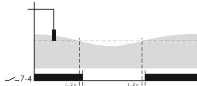
Режим откачки (трехфазный насос, поплавковый зонд)
