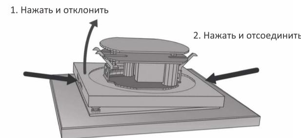
Рис. 2 Порядок рассоединения сенсорной панели и интерфейсного блока Q600WV.
