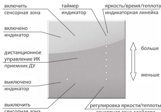
Рис. 3 Назначение элементов сенсорной панели Q600WV.
