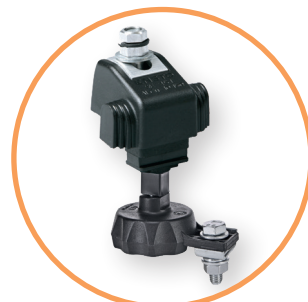
→ Затискач, тип "S" із проколом ізоляції з одного боку, обладнаний болтом із зривною голівкою і можливістю встановлення під напругою, 10 - 150 mm 2
