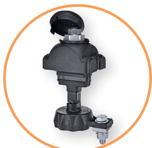
→ Затискач, тип "FK" з проколом ізоляції з двох боків, оснащений болтом зі зривною голівкою і можливістю встановлення під напругою, 10 - 95 mm 2
