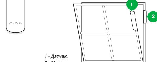
Датчик наклона определяет отклонение устройства в вертикальной плоскости более чем на 5°. DoorProtect Plus можно устанавливать на окна, в том числе мансардные, и ставить систему на охрану, когда они находятся в режиме проверки (предварительно отключив магнитный датчик в настройках).
